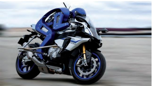
Yamaha ha sviluppato un robot in grado di guidare una moto.
